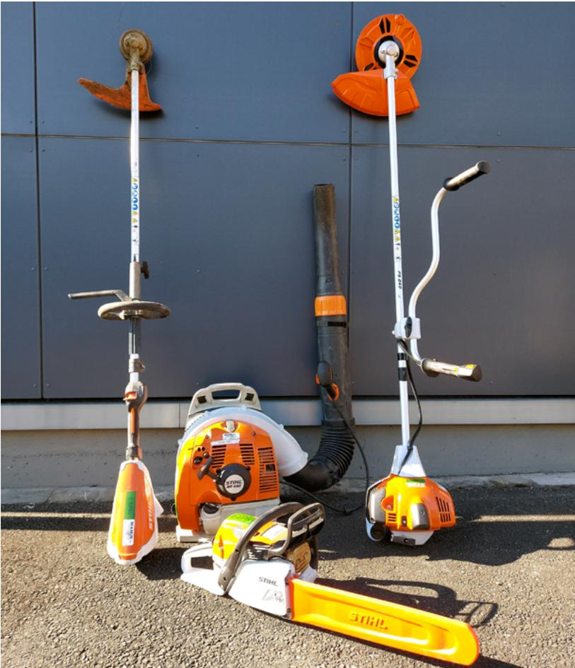
**DE GAUCHE À DROITE :** DÉBROUSILLEUSE ÉLECTRIQUE POUR LA FAUCHE DES HAUTES HERBES ; SOUFFLEUSE POUR PROCÉDER AU NETTOYAGE DES ZONES DE TRAVAIL ; DÉBROUSILLEUSE THERMIQUE AVEC DISQUE POUR LES TÂCHES PLUS DIFFICILES ; TRONÇONNEUSE POUR EFFECTUER DES COUPES DE BOIS DE BRANCHES
